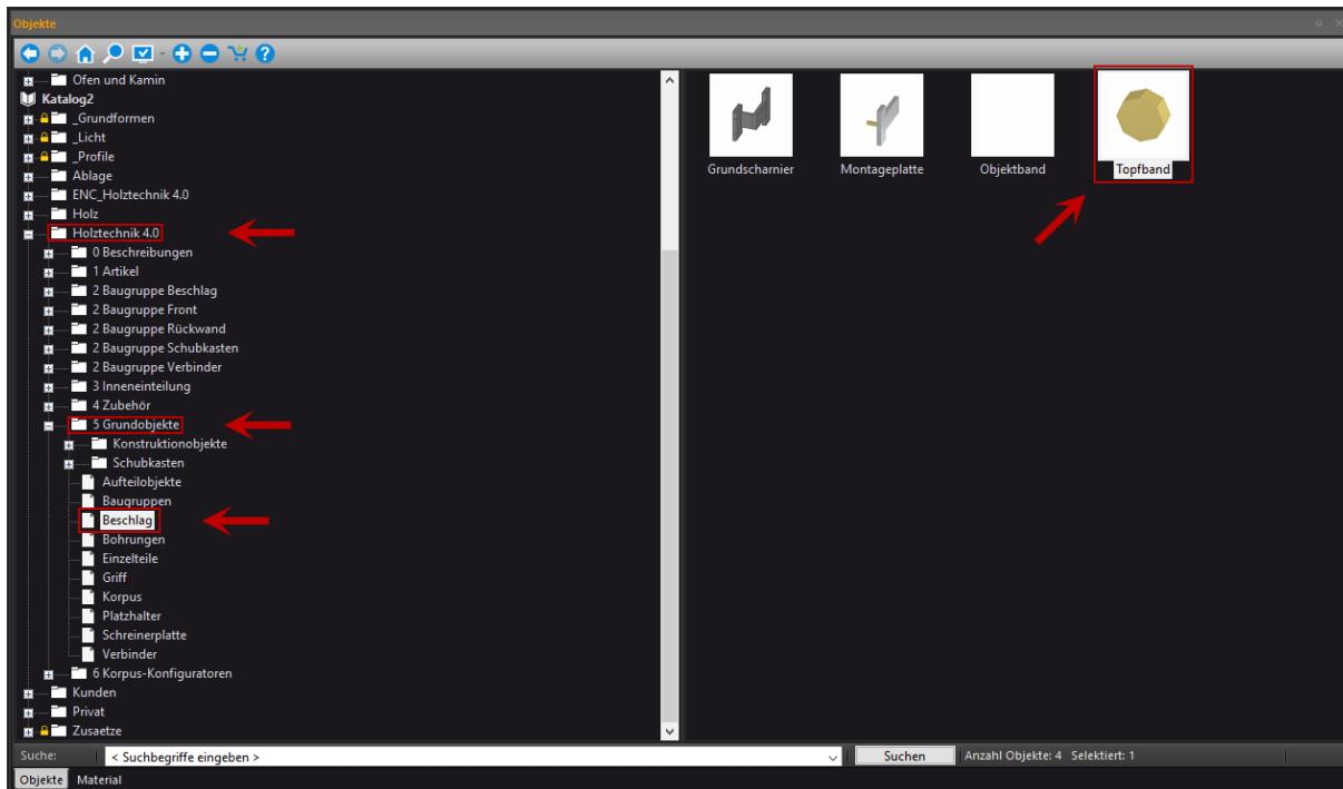
Nachdem der Beschlag in die Planung abgesetzt wurde, öffnet man durch einen weiteren Doppelklick auf den Beschlag, oder durch markieren des Beschlags und betätigen des Tastenkürzels **i**, dessen Intelligenz.
